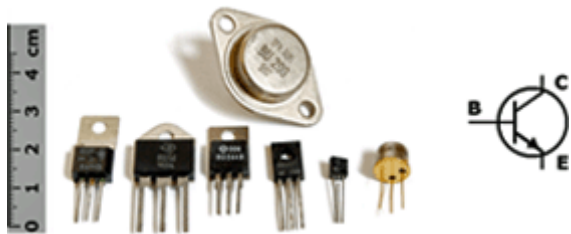
Zeven transistors. Rechts het schemasymbool van een transistor (nnp)
