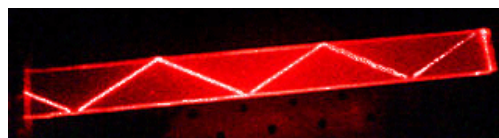
Totale terugkaatsing in een staafje PMMA
